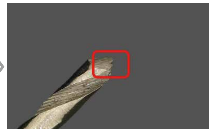
DSX1000 采用了平面照明, 因此易于观察到受损部位 (24X)
